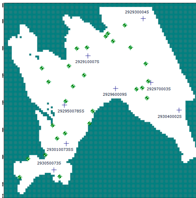
Figura 15. Piezómetros considerados en régimen transitorio. La evolución de los identificados numéricamente se expone en la Figura 16.
